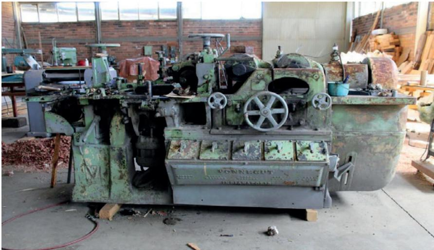
Figura 4. Maquinaria que se utiliza para hacer las molduras en la Fábrica de Cuadros y Marcos de Monte Escobedo (cortesía Antonio M.G.).
