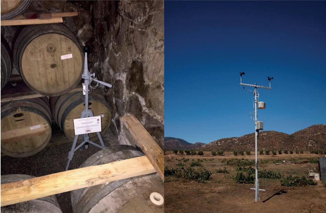
**Figura 3.** Izquierda: Sensores para mediciones de TBS, HR y TGN y derecha: Estación meteorológica. Fuente: Fotos del autor (2017).
