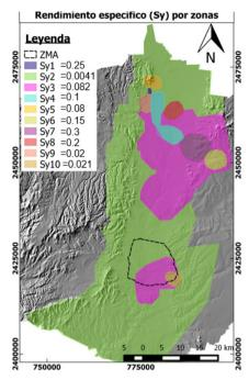
Figura 5. Rendimiento específico por zonas Sy1, Sy2 y Sy3 fueron tomados de UNAM-UAQ (2002). Lo valores Sy4, Sy5 y Sy6 Sy7, Sy8, Sy9 y Sy10 fueron tomados del reporte realizado por la UNAM para Conagua en 2009. ZMA = Zona Metropolitana de Aguascalientes
