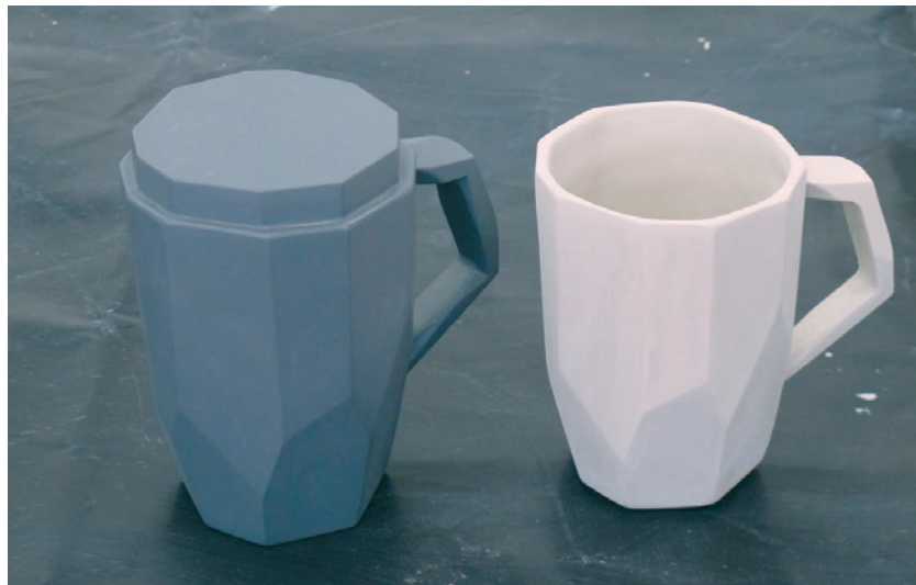
Figura 49. Comparativa entre la matriz y el objeto extraído del molde
