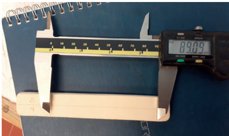
Figura 4. Medición de la probeta posterior a la quema
