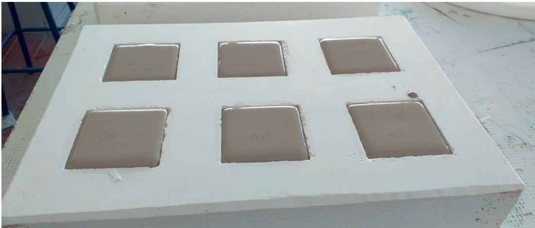
Figura 34. Vaciado de barbotina en molde
