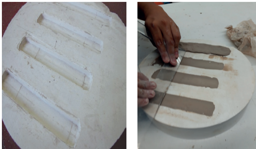
Figura 12. Izquierda: Molde de yeso de cuatro cavidades Figura 13. Derecha: Elaboración de cuatro probetas para cada formulación
