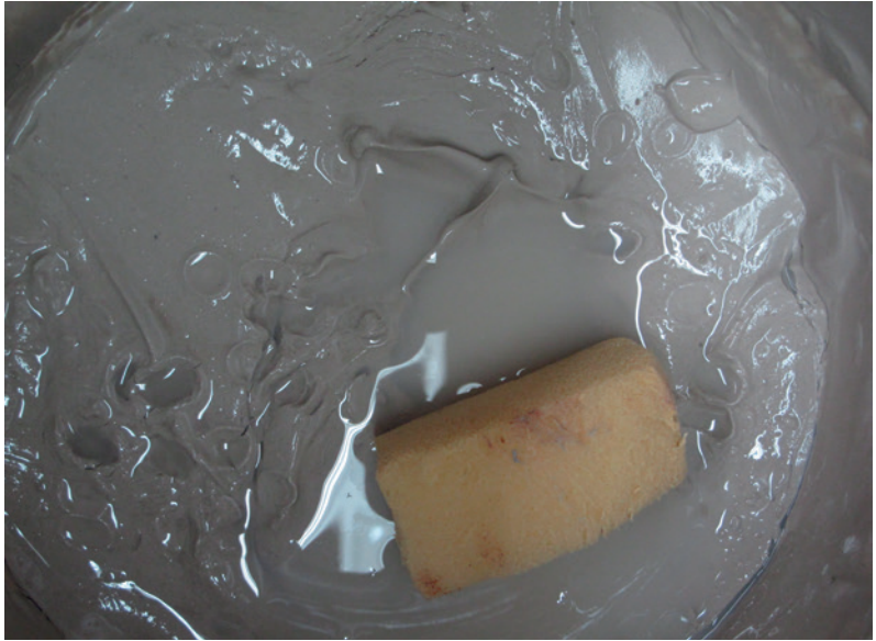
Figura 39. Exceso de agua en proceso de extracción con esponja
