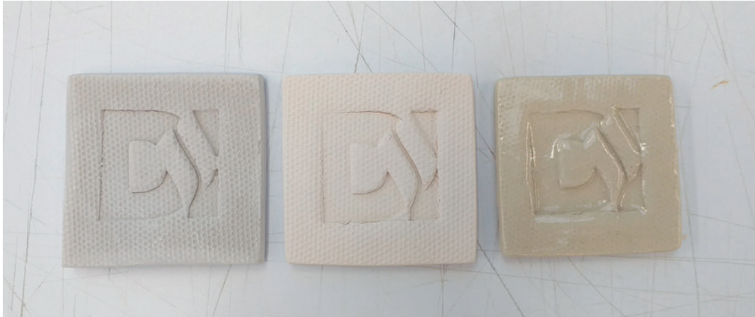
Figura 23. Pobetas planas realizadas con placas en sus tres estados: verde, sancocho y esmalte
