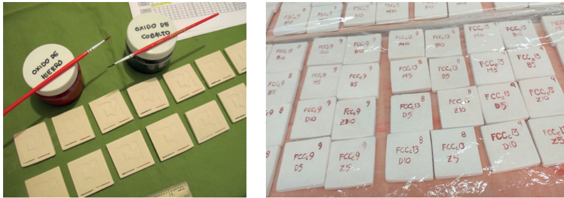
Figura 20. Izquierda: Marcaje de probetas Figura 21. Derecha: Formulaciones de vidriados y conos de quema
