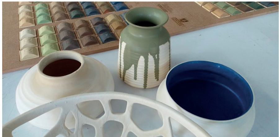
Figura 1. Piezas y catálogo de vidriados de gres desarrollados por los autores (1280°C)
