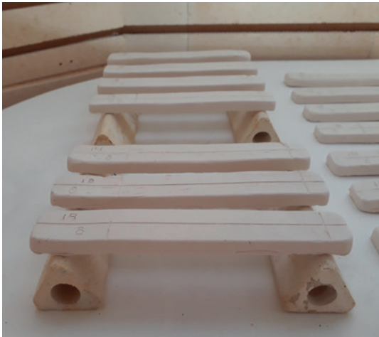
Figura 7. Izquierda: Probetas colocadas en el horno antes de ser horneadas
