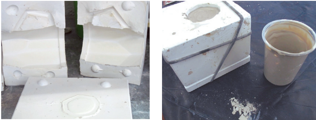
Figura 47. Izquierda: Molde de yeso de tres partes (taceles) Figura 48. Derecha: Vaciado de barbotina en el molde cerrado
