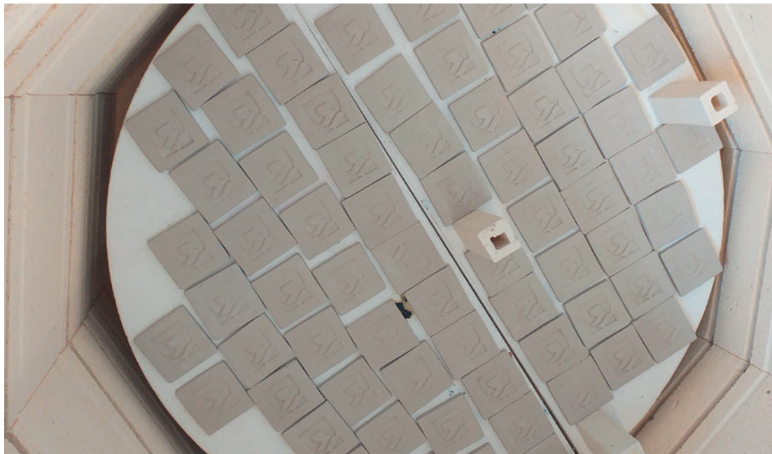
Figura 22. Colocación de probetas en horno eléctrico para quema de esmaltes
