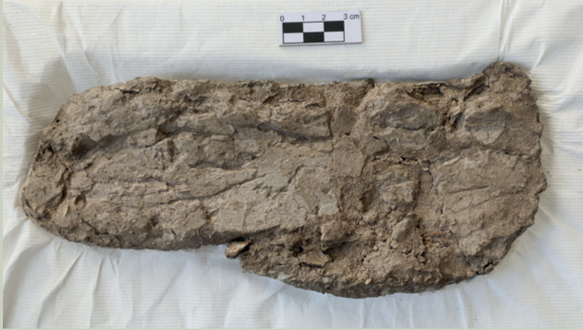
Imagen 4. Detalle del enjarre del muro; de acuerdo al análisis realizado, se identificó una mezcla fina de arcilla, arena y agua, aplicada sobre la superficie que posteriormente fue alisada (G. Sifuentes)
